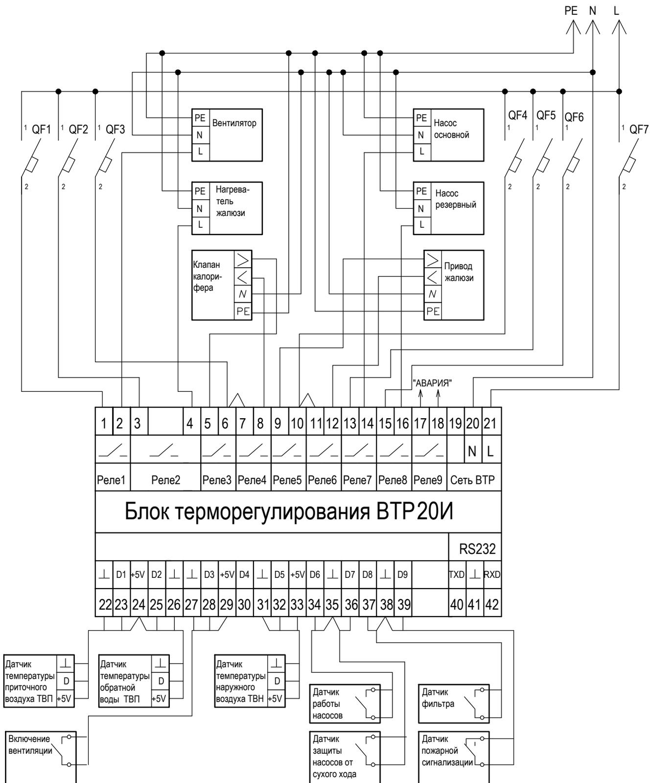
**Рисунок В.10-Схема подключения регулятора ВТР 20И (программа 33) в системе управления приточной вентиляцией**
