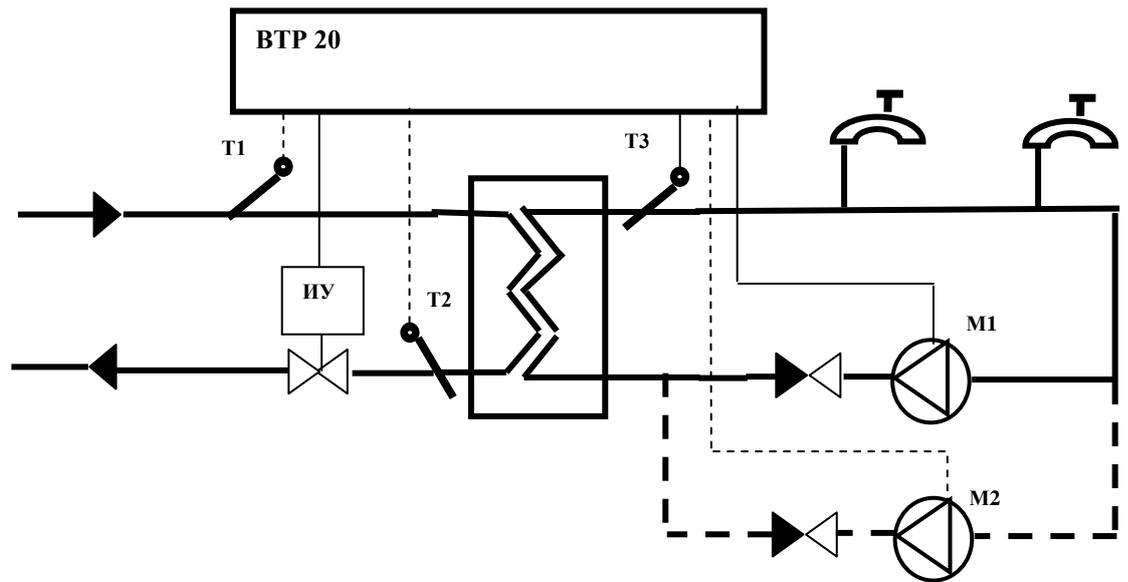
**Рисунок Б.3 – Монтажная схема регулятора ВТР-20 (программа 20) в системе управления одним контуром ГВС**
