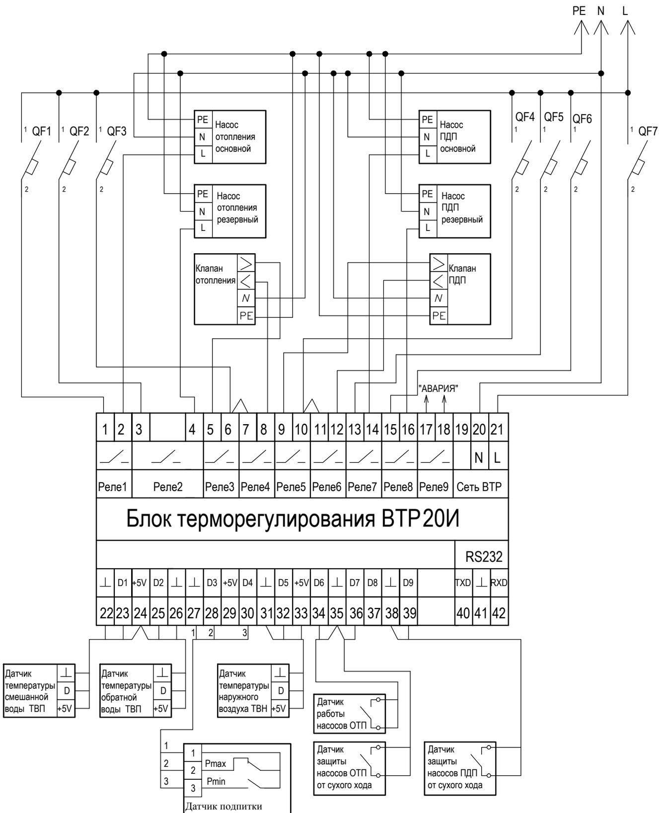
**Рисунок В.4-Схема подключения регулятора ВТР 20И (программа 14) в системе управления контуром отопления и контуром подпитки**
