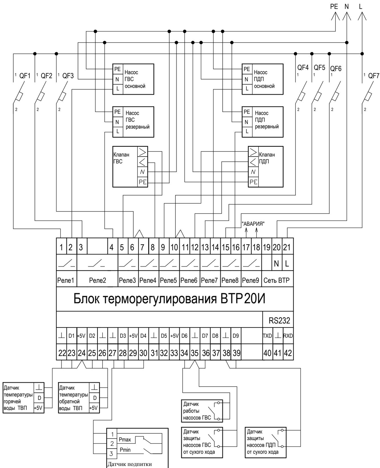
**Рисунок В.8-Схема подключения регулятора ВТР 20И (программа 24) в системе управления контуром ГВС и контуром подпитки**
