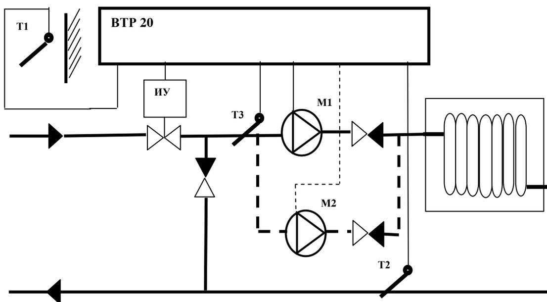
**Рисунок Б.2 – Монтажная схема регулятора ВТР-20 (программа 10) в системе управления одним контуром зависимой системы отопления**
