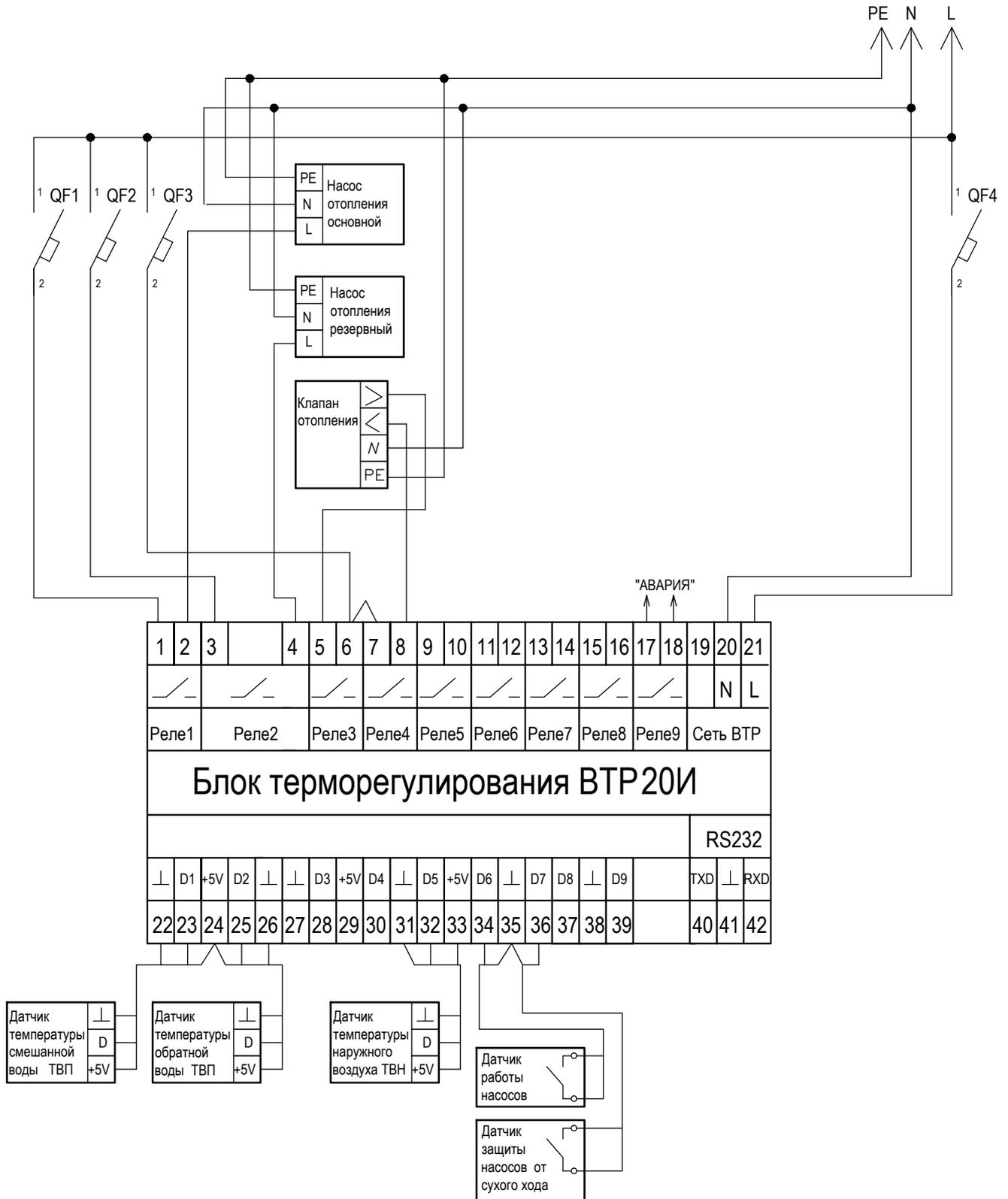
**Рисунок В.1-Схема подключения регулятора ВТР 20И (программа 10)
