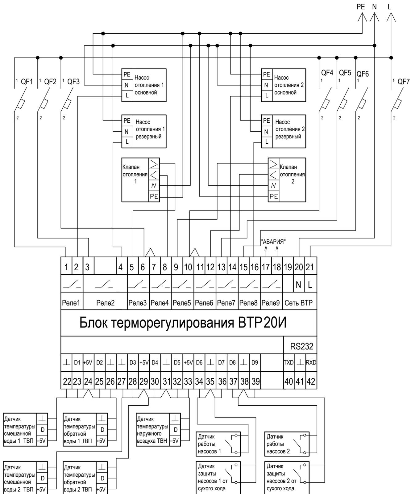
**Рисунок В.2-Схема подключения регулятора ВТР 20И (программа 11) в системе управления двумя контурами отопления**
