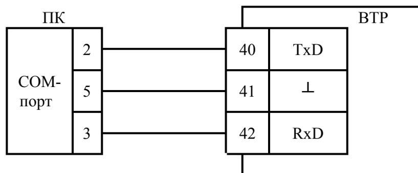
Рисунок 4.1 - Схема подключения ПК к блоку ВТР
