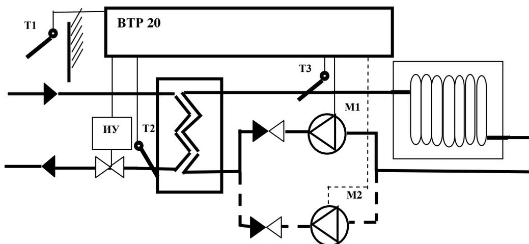
**Рисунок Б.1 – Монтажная схема регулятора ВТР-20 (программа 10) в системе управления одним независимым контуром отопления**
