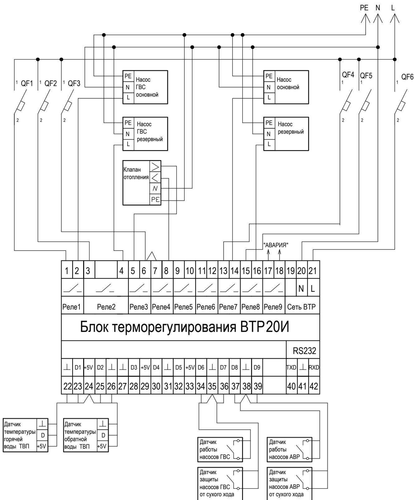
**Рисунок В.9-Схема подключения регулятора ВТР 20И (программа 25) в системе управления контуром ГВС и контуром АВР насосов**
