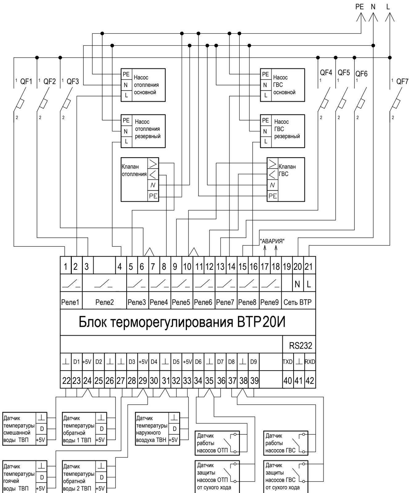
**Рисунок В.3-Схема подключения регулятора ВТР 20И (программа 12) в системе управления контуром отопления и контуром ГВС**
