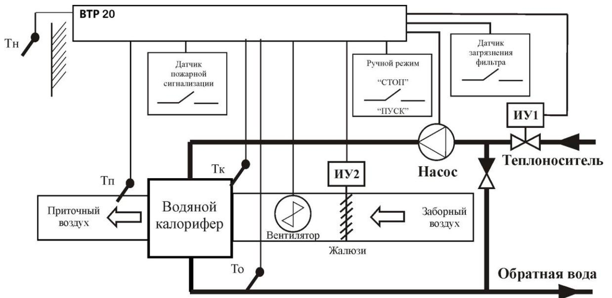
**Рисунок Б.4 – Монтажная схема регулятора ВТР-20 (программа 33 ВЕНТ) в системе управления приточной вентиляцией**
