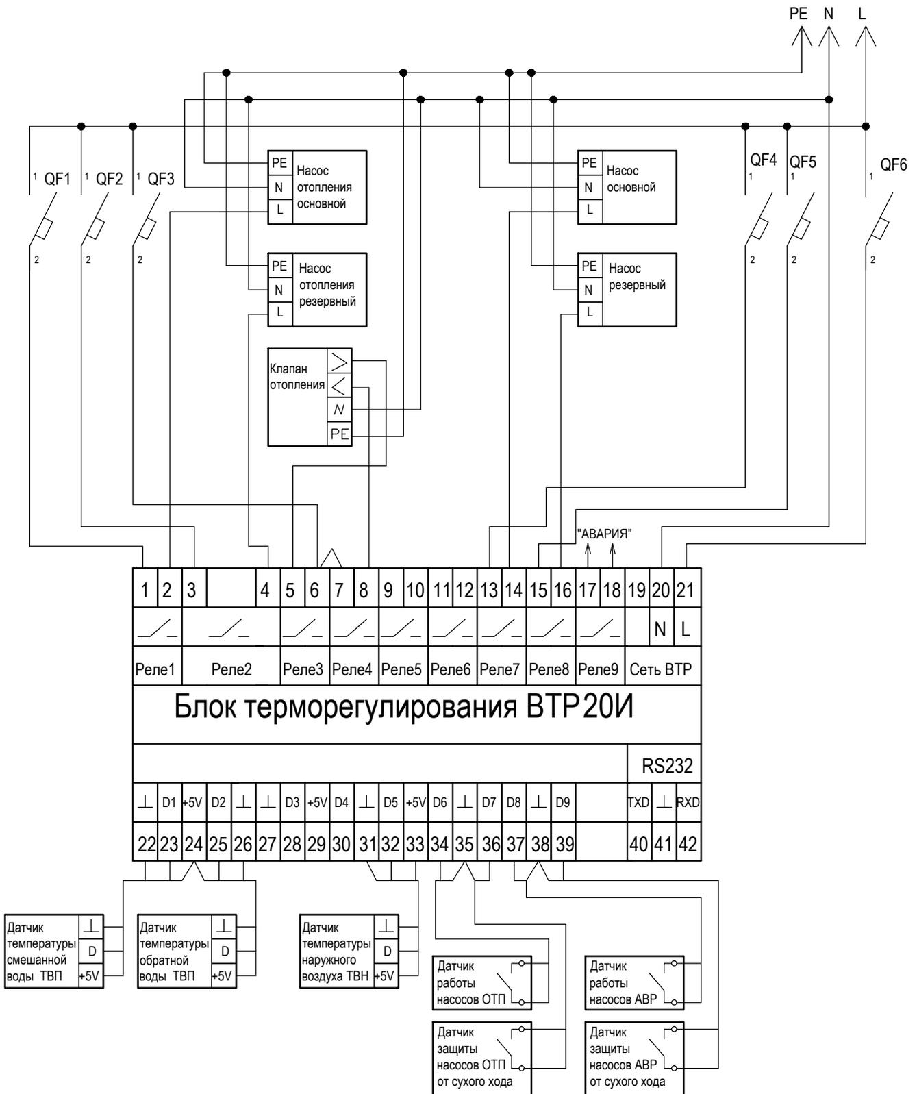
**Рисунок В.5-Схема подключения регулятора ВТР 20И (программа 15) в системе управления контуром отопления и контуром АВР насосов**
