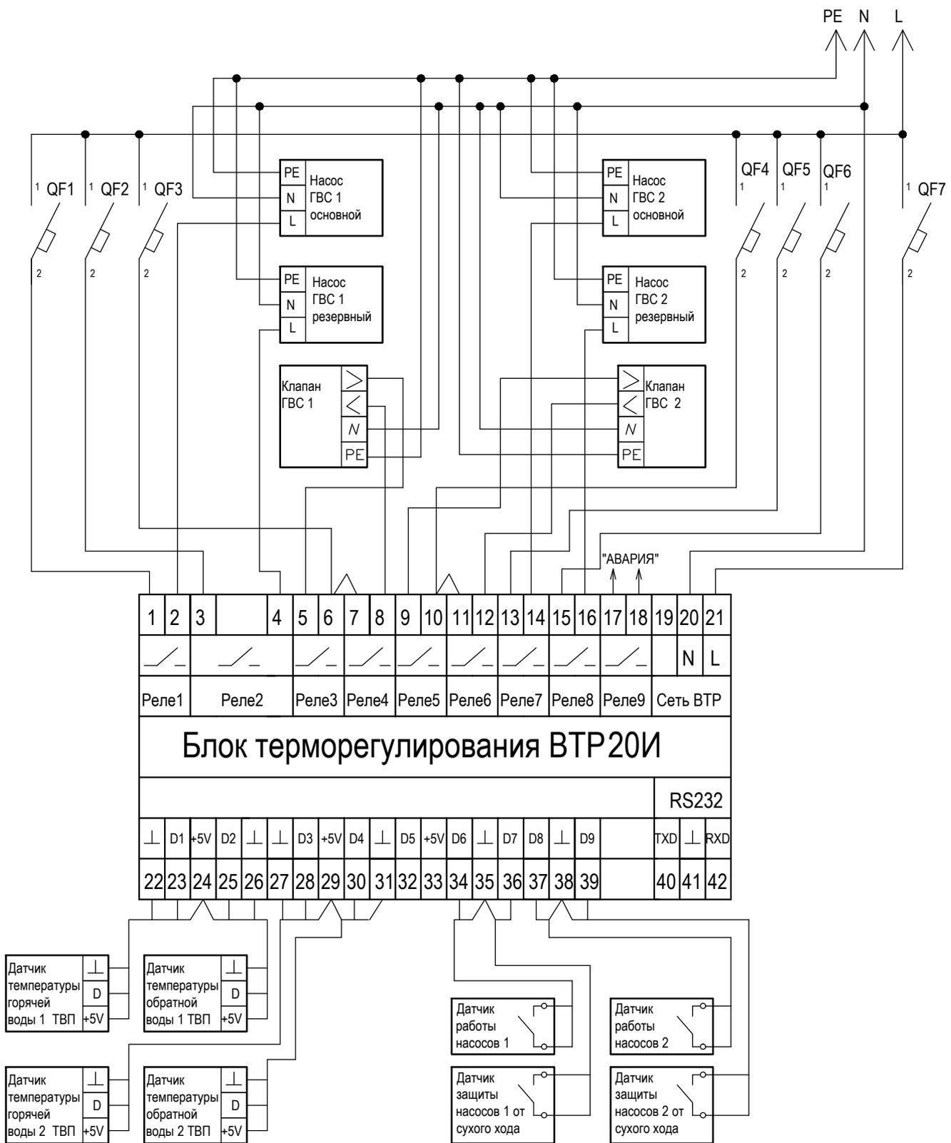
**Рисунок В.7-Схема подключения регулятора ВТР 20И (программа 22) в системе управления двумя контурами ГВС**
