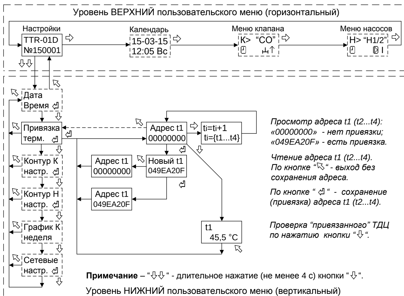
Рисунок 3 - Пример программирования (привязки) ТДЦ
