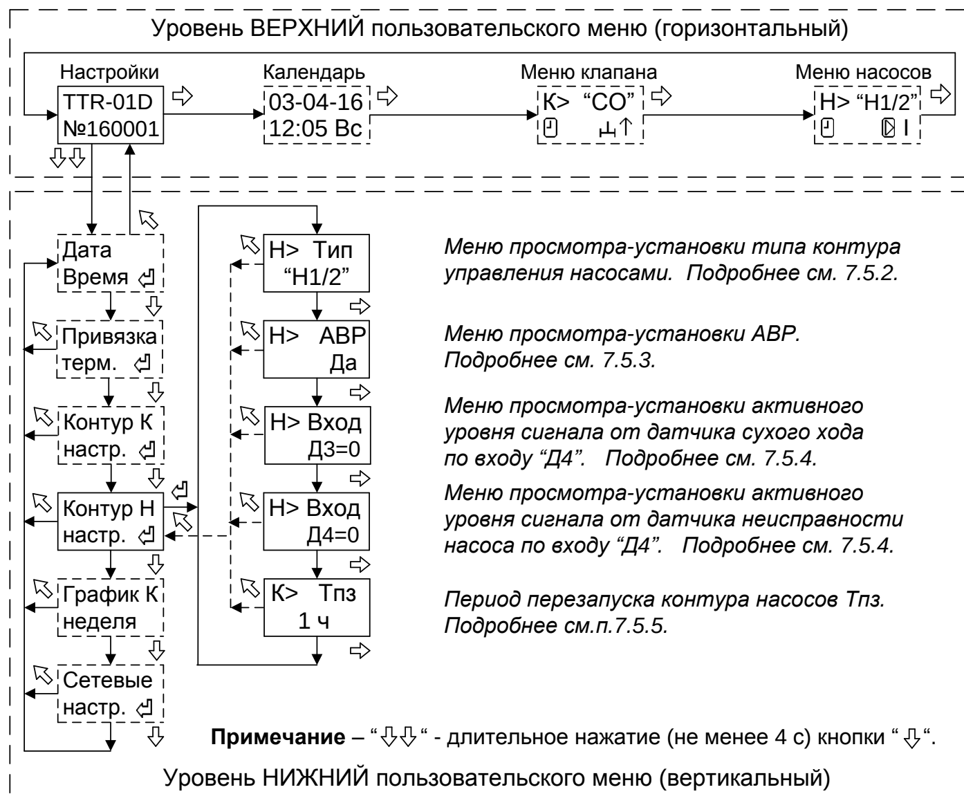
Рисунок 9 - Структура меню настройки параметров контура управления насосами.
