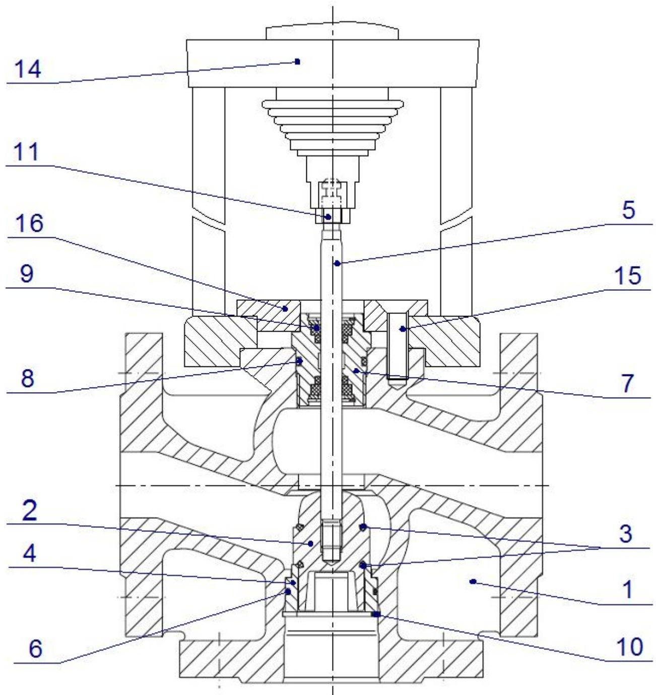
Рисунок А.2 Устройство клапана для DN65-DN100
