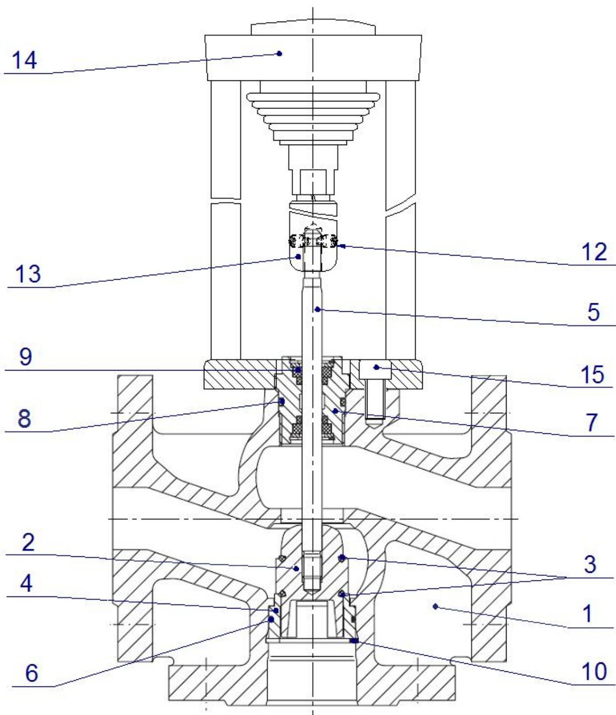
Рисунок А.1 Устройство клапана для DN15-DN50
